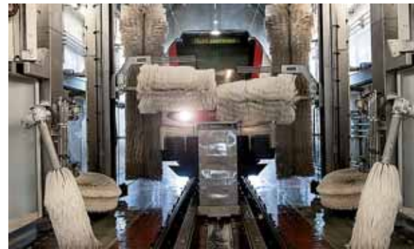
C7000 mit Seiten-, Horizontal-, Schürzen-, Dachschrägen- und Schwellerbürsten
