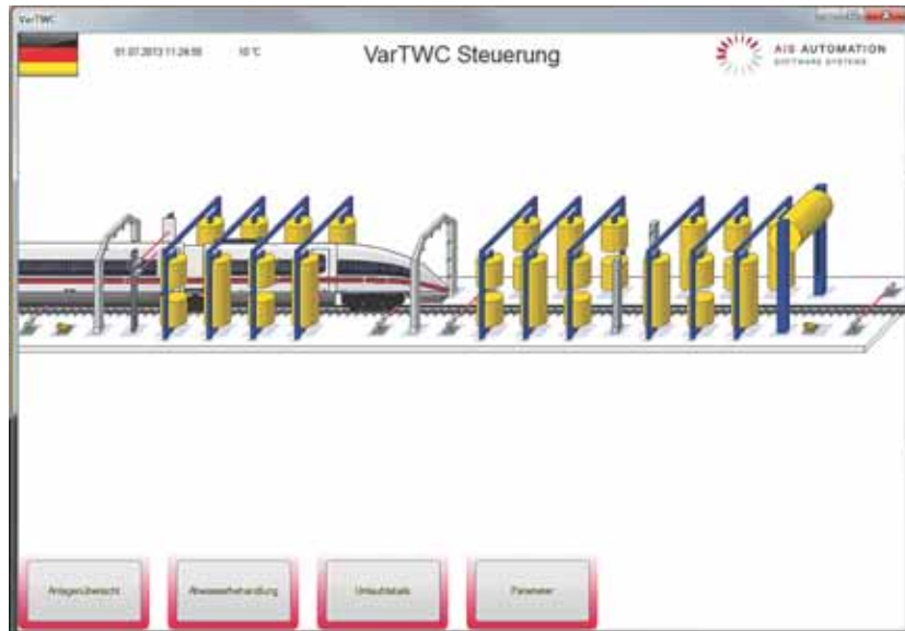
Die datenbankgestützte, modulare Außenreinigungsanlagensteuerung VarTWC ist anwenderfreundlich konzipiert.
