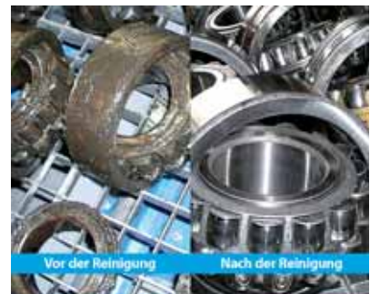
Reinigung bis in die Nut: Lager werden effizient und gründlich von Fett und Schmutz befreit.
