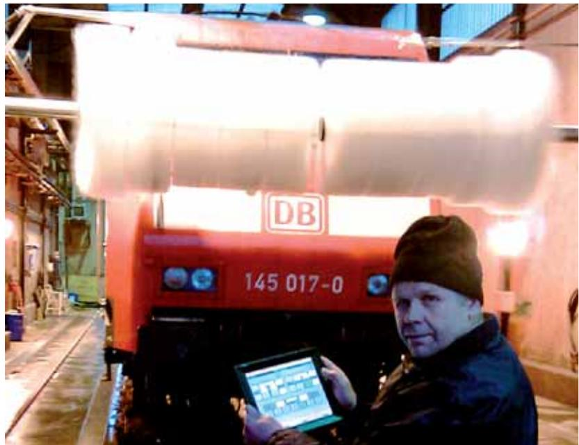
Per Tablet-PC oder Smartphone kann die Waschanlage bequem aus der Nähe angesteuert werden.
