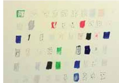
Der Test im Labor zeigt: Auf speziell ausgerüsteten Pulverlackbeschichtungen haften viele Tinten und Lacke nicht.
