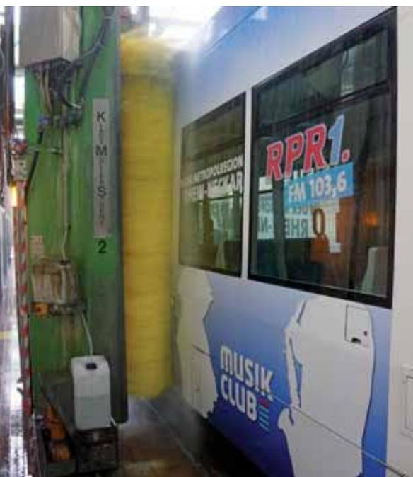
Reinigung am Standort Mannheim-Möhlstraße – Einsatz des oberflächenschonenden Reinigers LoClean Alk mit gleichmäßigem Sprühbild und optimal konturierten Bürsten
